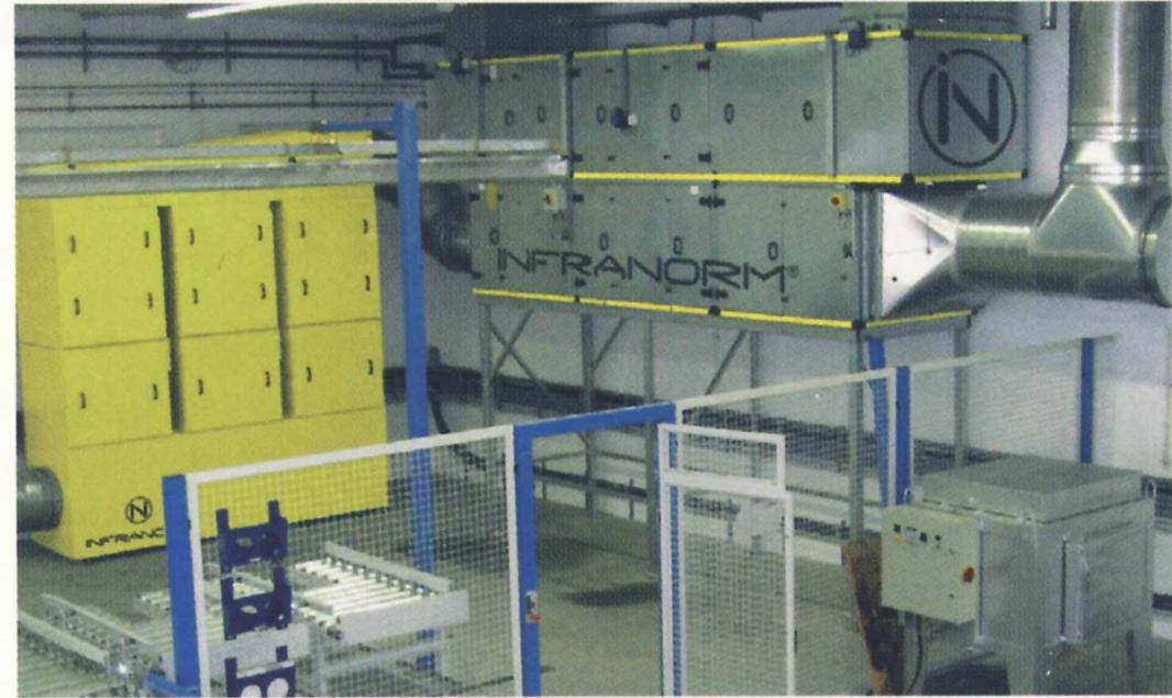
Härterei – Ölfilteranlage mit energiegesteuerter Wärmerückgewinnung.
